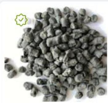
Quellon HD Bentonit Pellets nach DIN 4904 für den...
